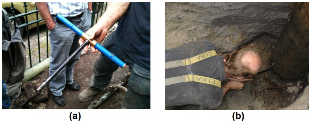
Figure 5. Carottier (a et prélèvement d'échantillon à l'aide du carottier (b)
