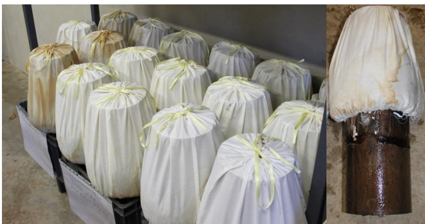
Figure 72 : Mini pieux bois partiellement immergés et placés au contact permanent d'un inoculum complexe d'organismes de dégradation du bois. A droite : détail d'un pieu du dispositif.
