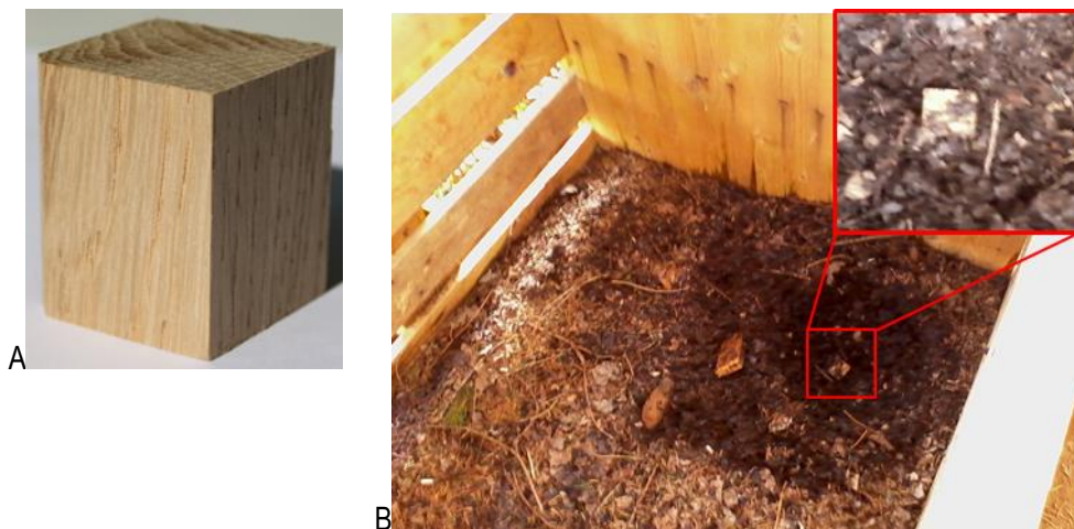
Figure 6 : Dispositif expérimental de dégradation semi-contrôlée. A) Exemple d'éprouvette placée en dégradation dans le microcosme terrestre B). L'insert montre une éprouvette en cours de dégradation, au contact avec l'inoculum.
