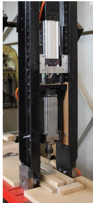
Figure 23 : A) Eprouvette de pin sylvestre percée en son centre, dans la direction radiale. B) Dispositif de perçage.
