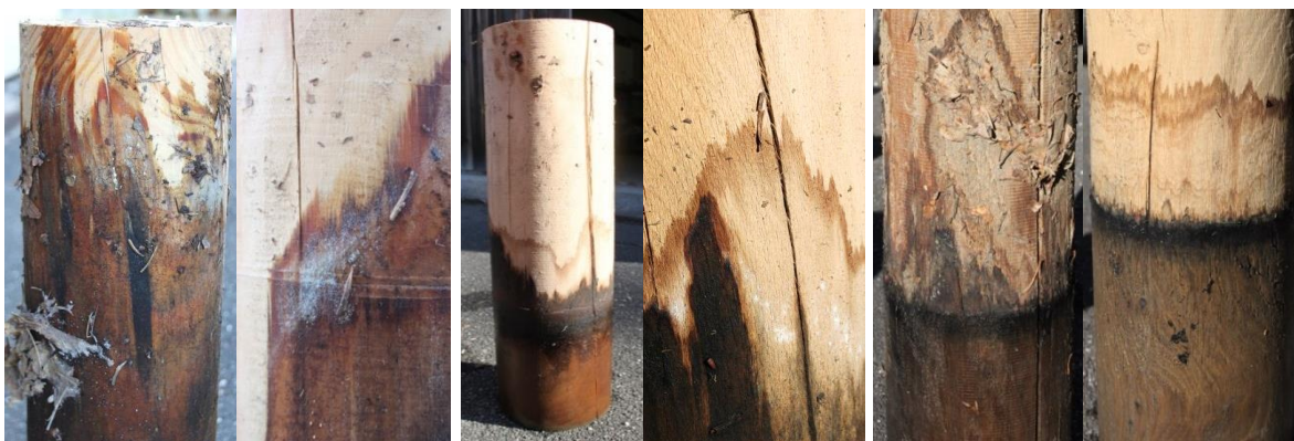
Figure 71 : Photographies des pieux, avant leur usinage en éprouvettes (temps de mise en eau : 6 mois)
