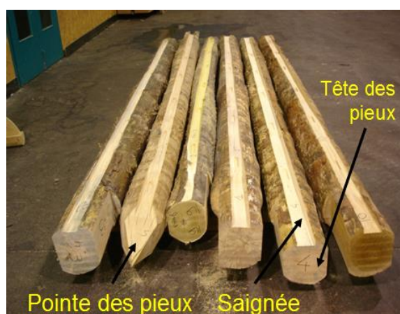
Figure 4. Saignée usinée sur le fût des pieux en bois
