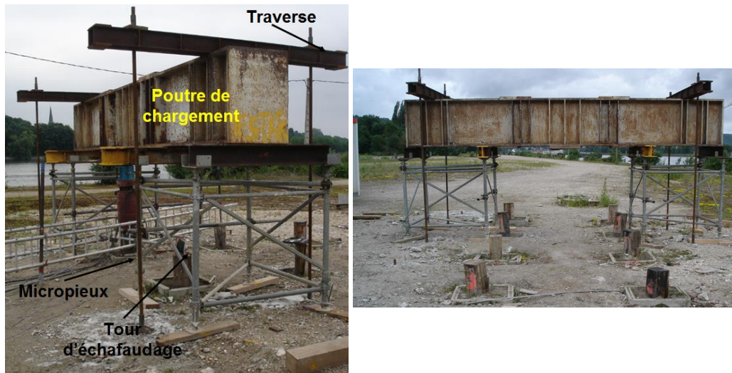
Figure 34. Massif de réaction
