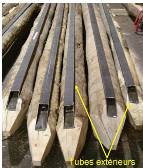
Figure 7. Fixation des tubes extérieurs métalliques à section carrée dans la saignée
