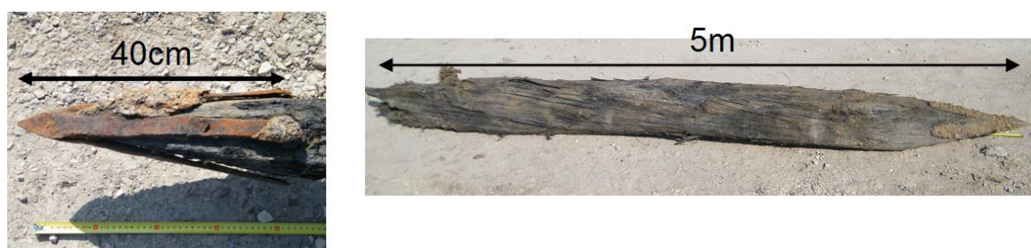
Figure 32. Pieux provenant d'une ancienne digue de la Saône (1673)
