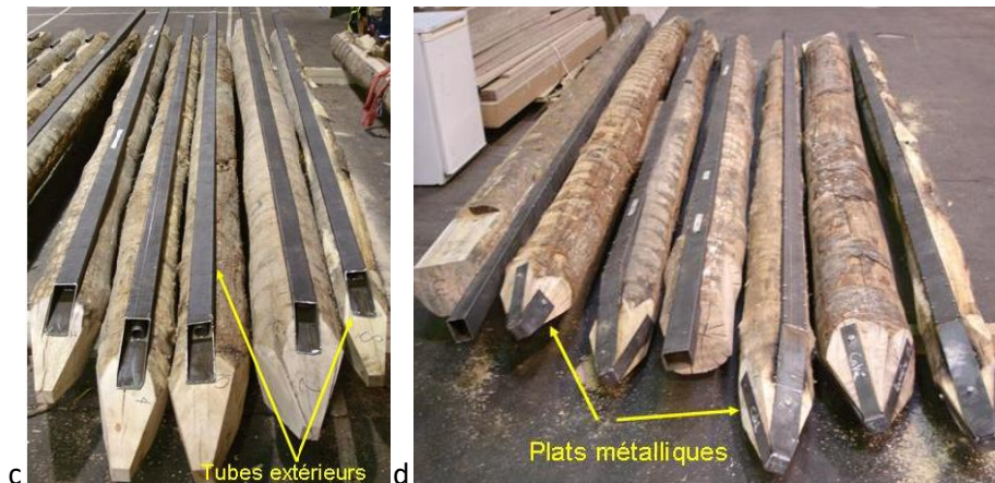
Figure 4 : Mise en palce de l'instrumentation : (a) saignée dans les pieux, (b) fixation des tubes sur les pattes, (c) fixation des tubes extérieurs dans la saignée, (d) protection de la pointe à l'aide de plats métalliques
